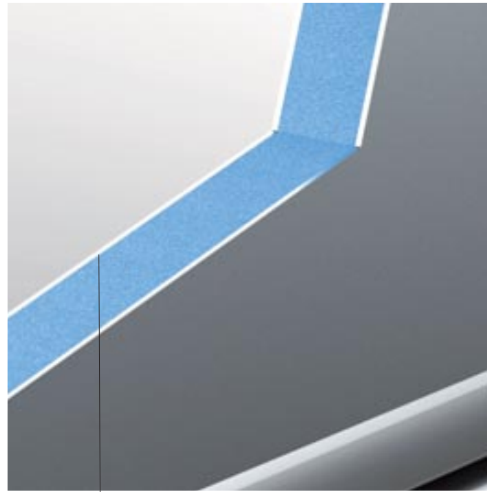
Aluminium beplating aan de wandbinnenkant als warmtegeleider
