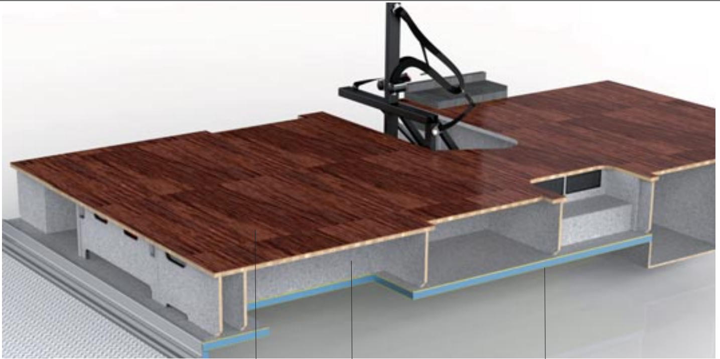
Vloer Massieve onderconstructie Met GFK-platen afgewerkte sandwichbodern
